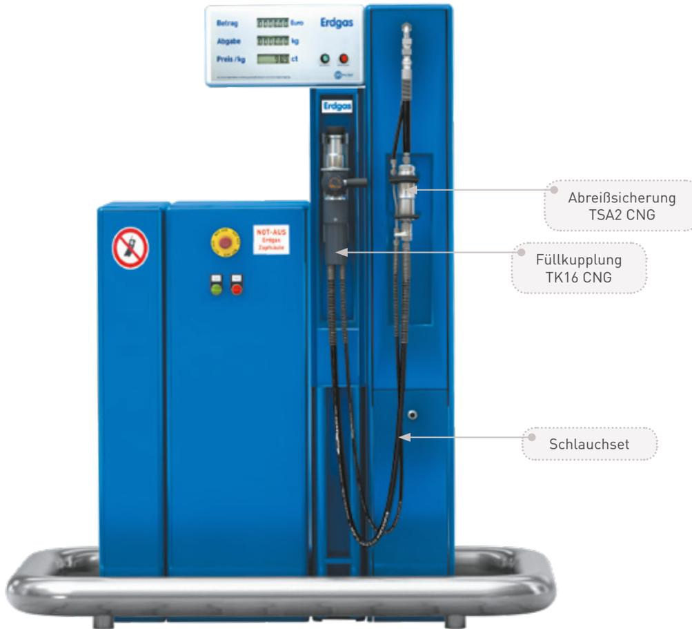
Zum Einbau an Tankstellen bieten wir Ihnen auch komplett montierte und druckgeprüfte Sets bestehend aus Füllkupplung, Schlauchset und Abreißsicherung an. Sie erhalten diese in verschiedenen Schlauchlängen und alternativ entweder mit der Abreißsicherung TSA1 CNG, welche direkt an der Zapfsäule integriert ist oder der In-line-Abreißsicherung TSA2 CNG, die zwischen den Schläuchen montiert wird.
